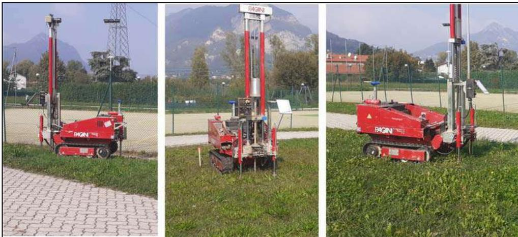
I dati ricavati tramite lo strumento in questione sono in tutto paragonabili a quelli della prova SPT (Standard Penetration Test) in foro di sondaggio; tale prova consiste *nell'infiggere verticalmente nel terreno una punta conica metallica posta all'estremità di un'asta d'acciaio, prolungabile con l'aggiunta di aste successive; l'infissione avviene per battitura, facendo cadere da un'altezza costante un maglio di dato peso.*
